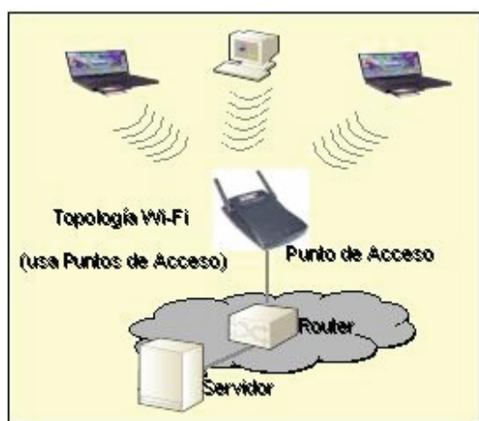
Figura 1. Esquema de red wifi
