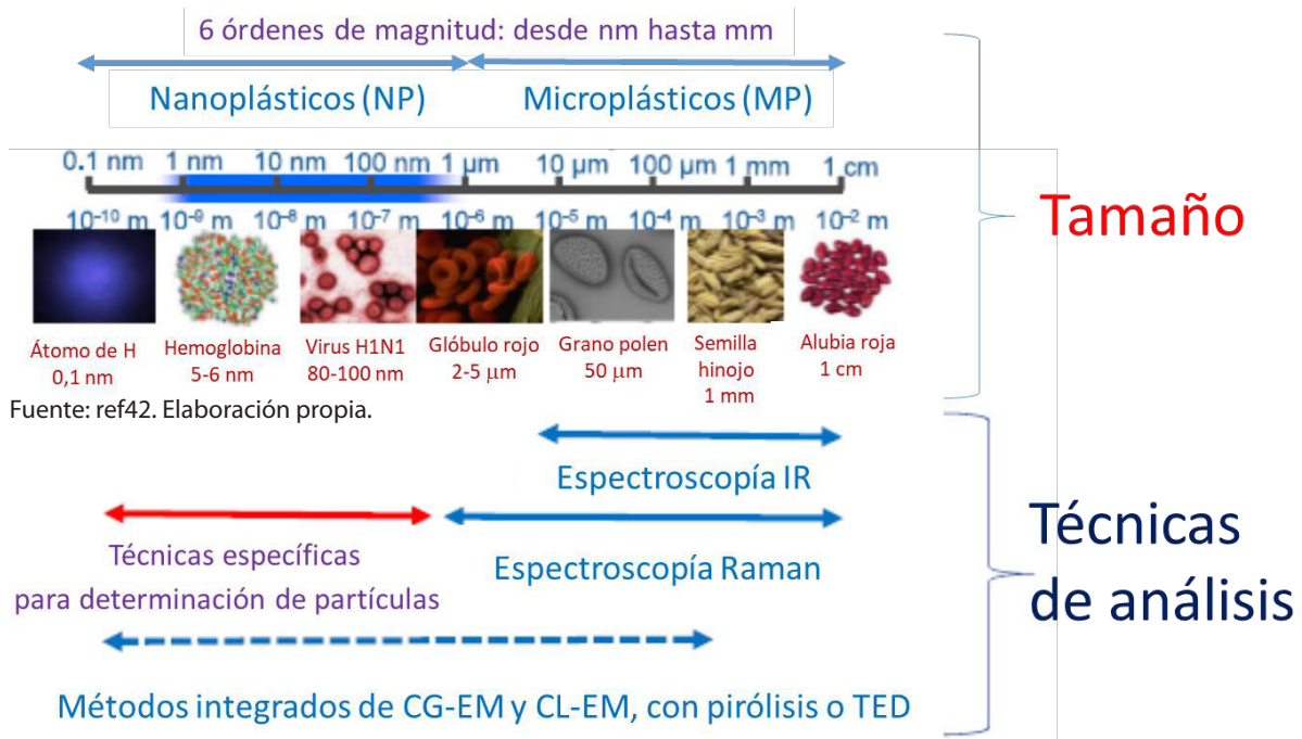
Figura 1. Tamaño de microplásticos y nanoplásticos en relación a diferentes sustratos, y técnicas de control aplicables
