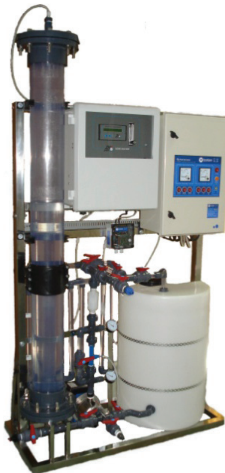
Figura 2. Planta piloto de ozonización
