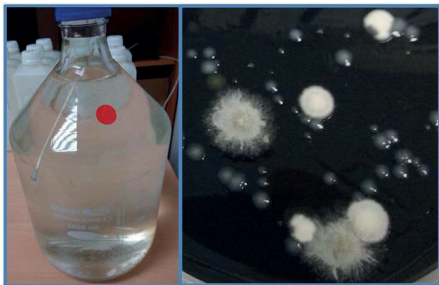
Figura 3. Quirófano en un hospital: muestra de agua/ ducha de un vestuario. Hongos interferentes dificultaron la interpretación de los resultados positivos de cultivo en una placa (10-12 días). La misma muestra fue positiva y cuantificable por SIM en solo 1 hora, días más tarde confirmada también por PCR (inicialmente negativa, el ADN se detectó solo tras tratamientos de la muestra).
